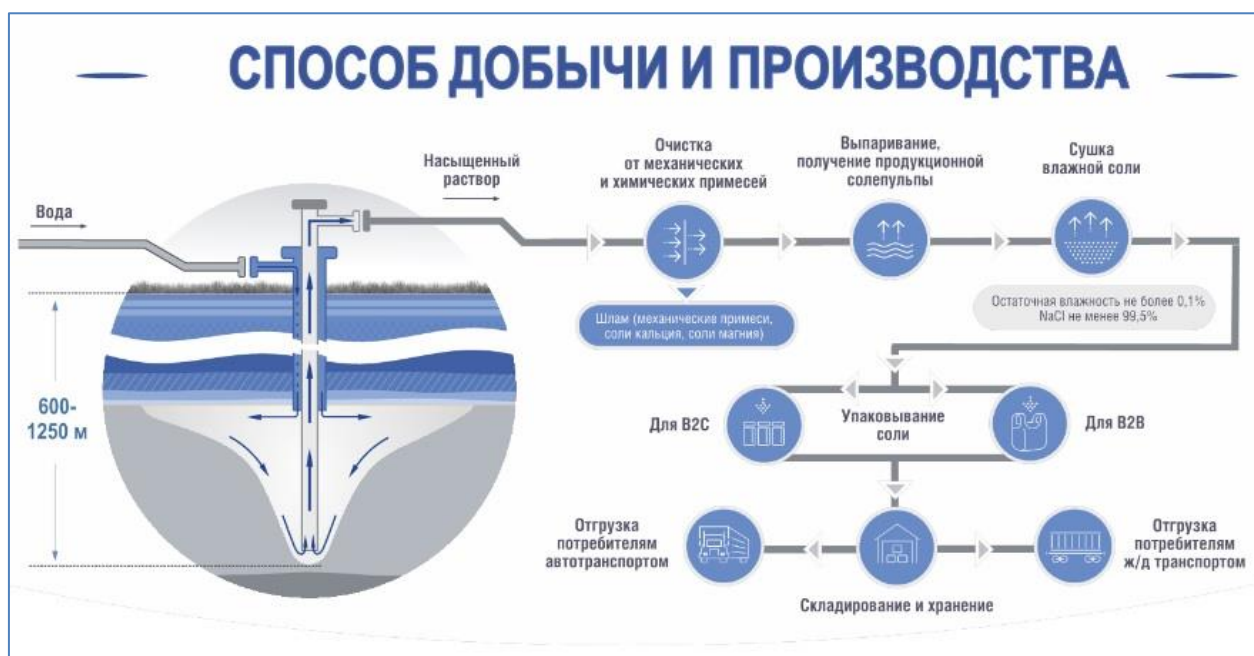
Рис. 1.1 – Схема способа добычи и производства поваренной соли на ОАО «Мозырьсоль».
