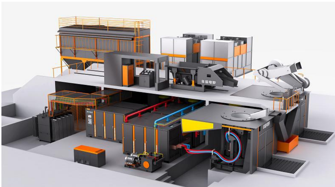
Рис. 1.2. Индукционный плавильный комплекс с печами GW-3T-2000 KW/0.5S
